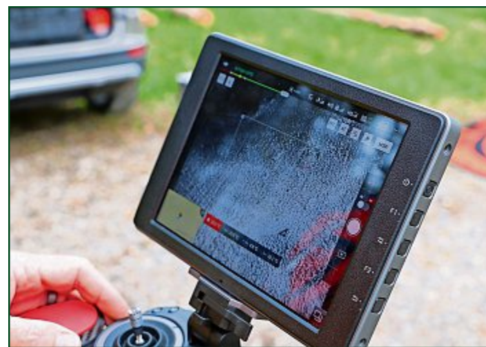
Mit der Wärmebildkamera kann ein warmes Objekt – also ein Rehkitz am Morgen, wenn der Boden noch kalt ist – gefunden werden.
